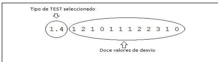
(Fig. 33) Observamos (de izquierda-derecha) la identificación del tipo de *test* 1.4, y seguidamente los 12 valores de desvío: 2 coincidencias (valores = 0); 6 desvíos a distancia de 1 altavoz (valores = 1); 3 desvíos a distancia de 2 altavoces (valores = 2); y 1 desvío a distancia de 3 altavoces (valores = 3).
